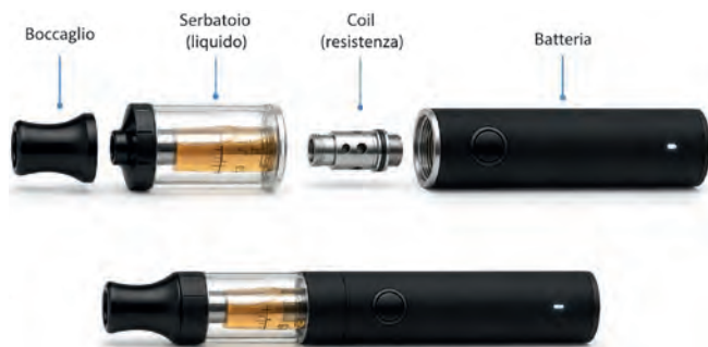
Figura 2. Struttura sigaretta elettronica.
